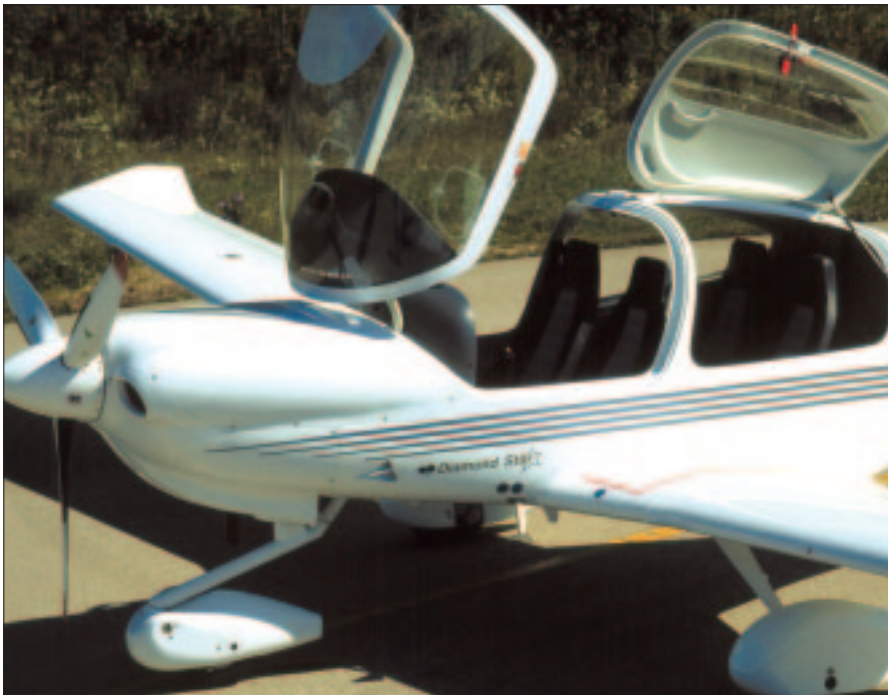
Diamond Aircraft erprobt verschiedene Kunststoff- und Kohlefaserstrukturen, um die eigenen Flugzeuge steifer und leichter zu machen.
